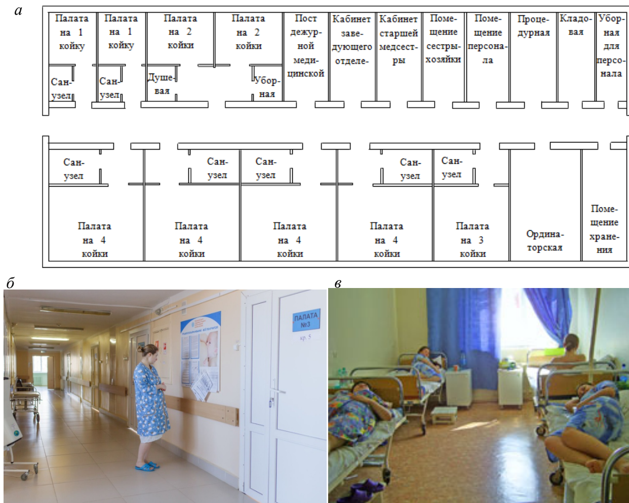
Рисунок 1.3 – Палатное отделение учреждения родовспоможения: а – план этажа; б – коридор в дневное время; в – палата на 4 койки
